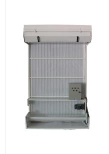
初效过滤器结构:外框主要包括:纸框、镀锌框、铝合金框、不锈钢板。有板式、和袋式结构。滤料:纤维滤料主要有:化纤类无纺布,玻璃纤维滤料,某些厂家有棉纤与化纤的混合滤料,其它还有金属网等。过滤效率=过滤器捕集粉尘量/上游空气含尘量=1-下游空气含尘量/上游空气含尘量效率的意义看似简单,可它的含义和数值却因试验方法的不同而大不一样。在决定过滤效率的因素中,粉尘"量"的含义多种多样,由此计算和测量出来的过滤器效率数值也就五花八门。实用中,有粉尘的总重量、粉尘的颗粒数量;有时是针对某一典型粒径粉尘的量,有时是所有粉尘的量;还有用特定方法间接地反映浓度的通光量(比色法)、荧光量(荧光法);有某种状态的瞬时量,也有发尘全过程变化效率值的加权平均量。对同一只过滤器采用不同的方法进行测试,测得的效率值就会不一样。各国家、各厂商使用的测试方法不统一,对过滤器效率的解释和表达大相径庭。离开测试方法,过滤效率就无从谈起。浙江过滤器产地过滤器,就选无锡市兆一环保科技有限公司,让您满意,有想法可以来我司咨询!
