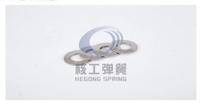
碟形弹簧是在轴向上呈锥形并承受负载的特殊弹簧,在承受负载变形后,储蓄一定的势能,当螺栓出现松弛时, 碟形弹簧释放部分势能以保持法兰连接间的压力达到密封要求。碟形弹簧应力分布由里到外均匀递减,能够实 现低行程高补偿力的效果。
